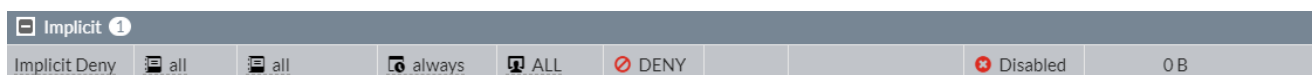
Figure 13 : Capture d'écran de la règle implicite placée à la fin du Fortigate 600D
